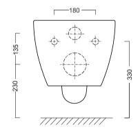
\* To be installed only on M12 bars | Installazione solo su barre M12
